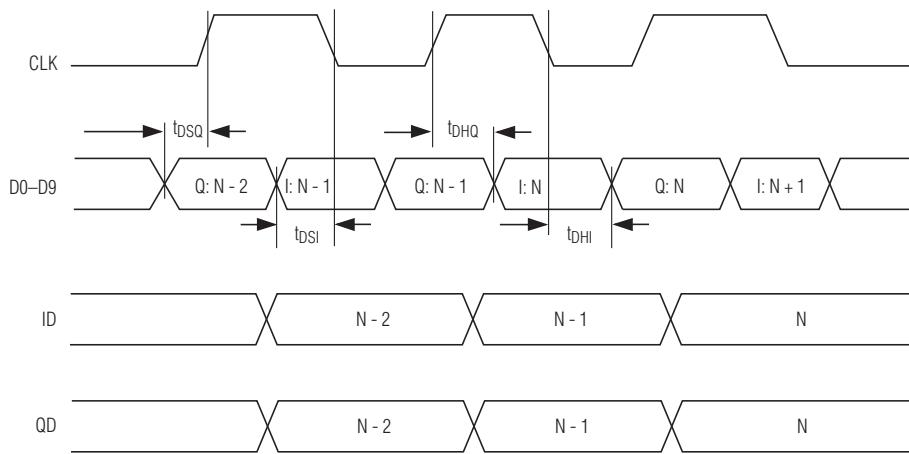
图5. Tx DAC系统时序图
