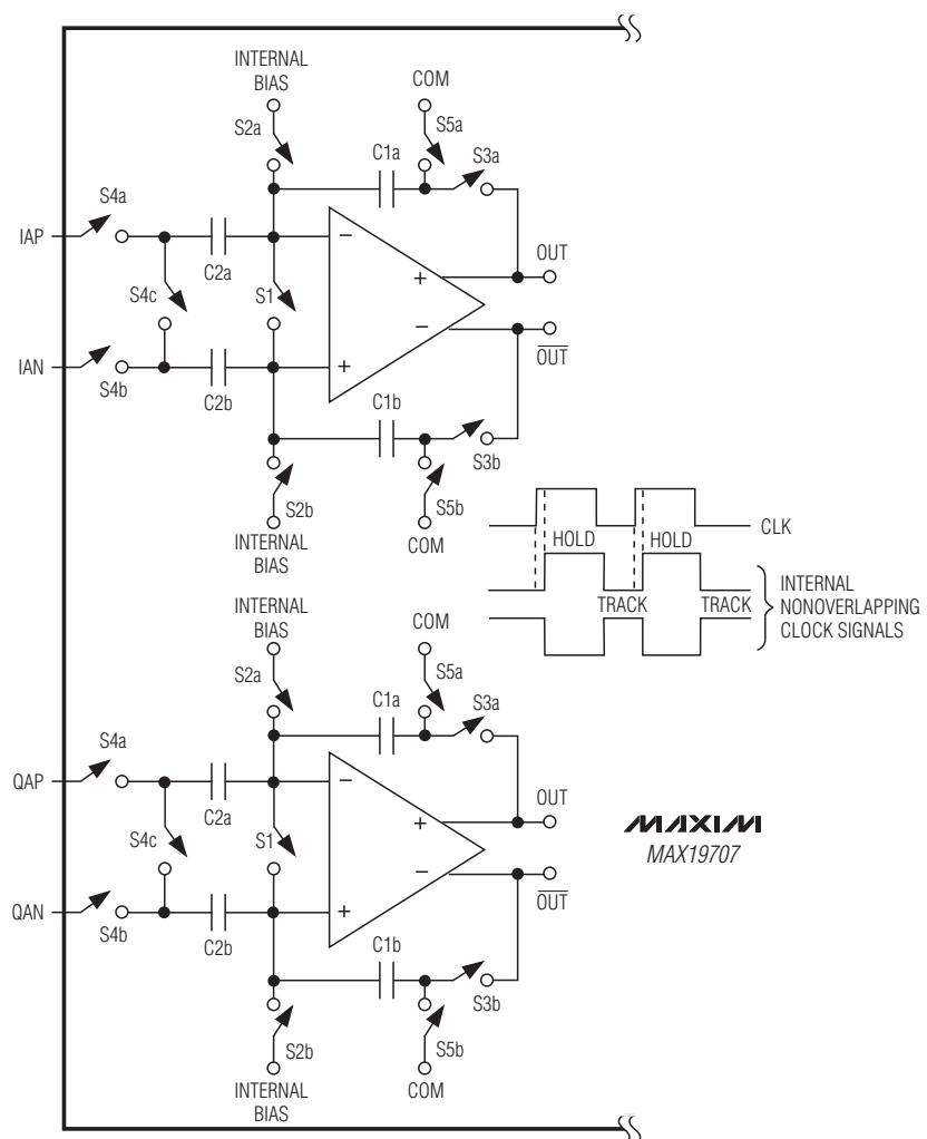
图1. Rx ADC内部T/H电路
