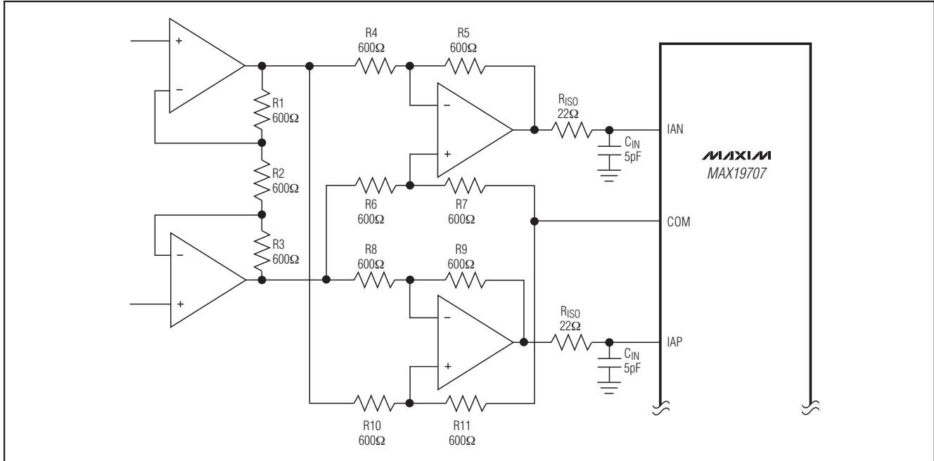
图11. Rx ADC 直流耦合差分驱动
