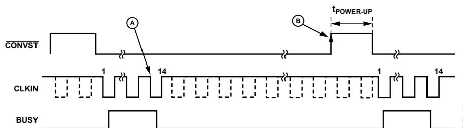
Figure 40. Autoshutdown/Autostandby Mode
