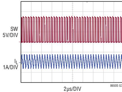
12V<sub>IN</sub> TO 5V<sub>OUT</sub> AT 100mA
