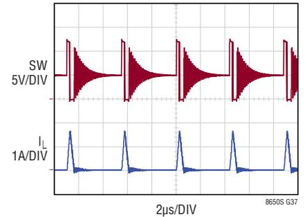
12V<sub>IN</sub> TO 5V<sub>OUT</sub> AT 100mA
