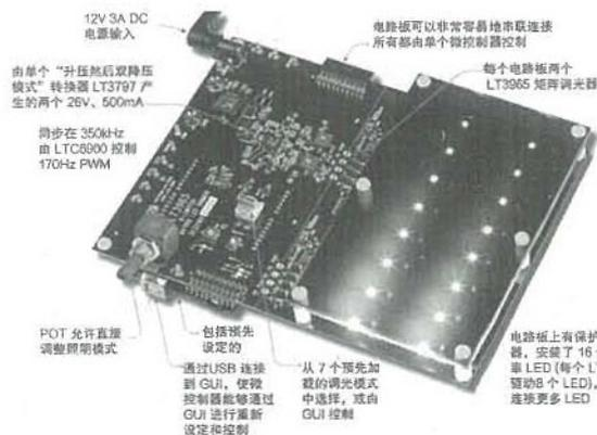
图1 LT3965 LED 矩阵调光器演示电路板 DC2218 作为 Arduino(DC2026)的屏蔽罩使用。这个演示电路板驱动前灯、转向灯、尾灯和装饰灯，可通过 USB 电缆连接到凌力尔特图形用户界面，以进行评估
