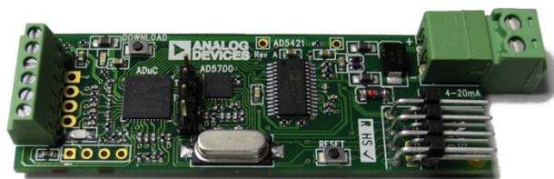
图4. HART注册的现场仪器仪表演示板
