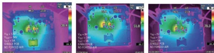
图3 两个LT3790 24V稳压器容易并联，以用分立式组件有限的温升来增大一倍输出
